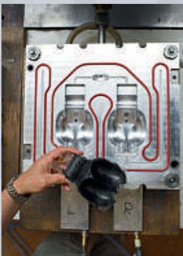
Raffinierte Lösung: Peltonbecher aus Faserverbund für Wasserkraftanlagen (Bilder: Fabian Stamm)
