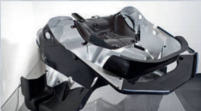
Hightech: extrem leichtes und temperaturstabiles Hitzeschutzschild für höchste Ansprüche. (Bild: Fabian Stamm)
